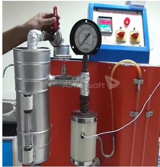
FIG: Throttling calorimeter
